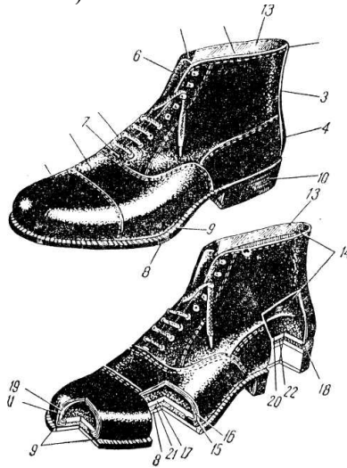
Рис. 1.15. Конструкція чоловічого хромового рантового черевика
