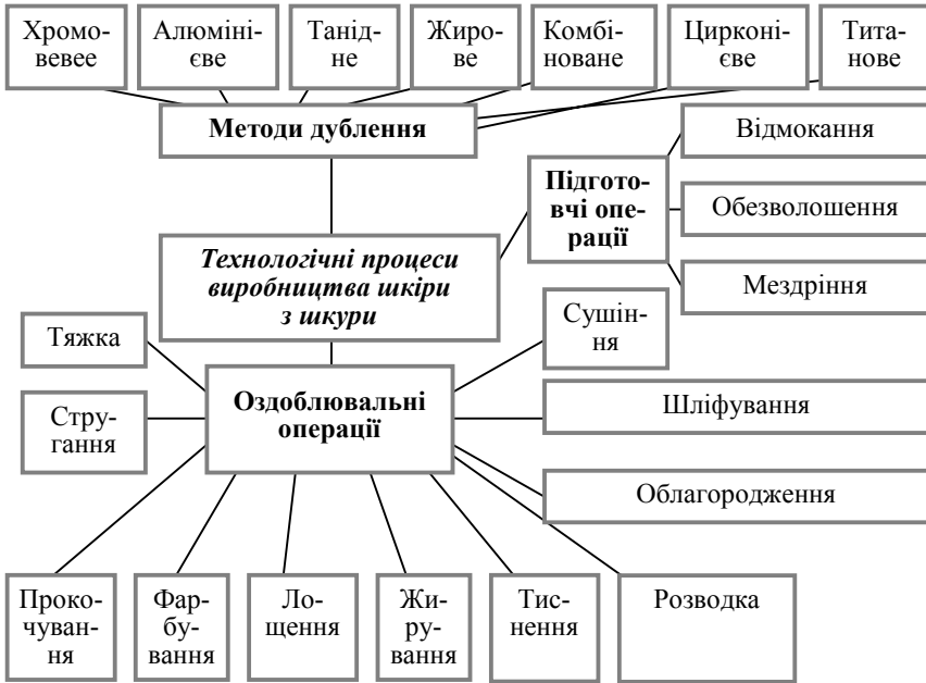
Рис. 1.8. Класифікація операцій виробництва шкіри
